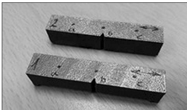
■ 10. ábra. Charpy próbatestenen feltüntetett maradófeszültségmérés pontjai
