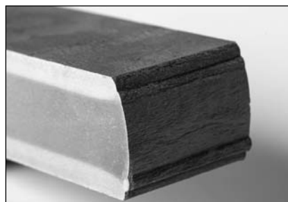
■ 6. kép. A thyssenkrupp által kifejlesztett TriBond anyag keresztmetszete. (Forrás: thyssenkrupp [20])
