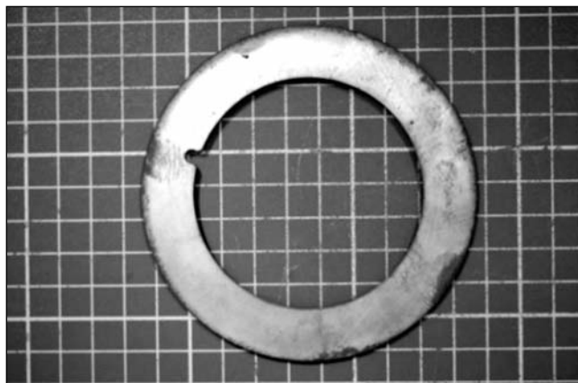
■ 1. ábra. A 101,5/69/1,35 mm-es próbatest
