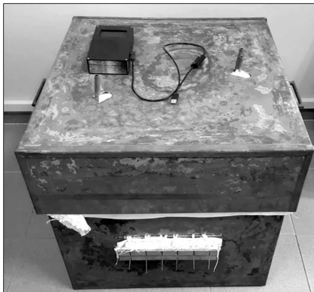
■ 8. ábra. Hőmérsékletmérő és regisztráló műszer, amely az előmelegítő kemencében a betéttel utazva gyűjti és tárolja a fémhőmérsékleti adatokat
