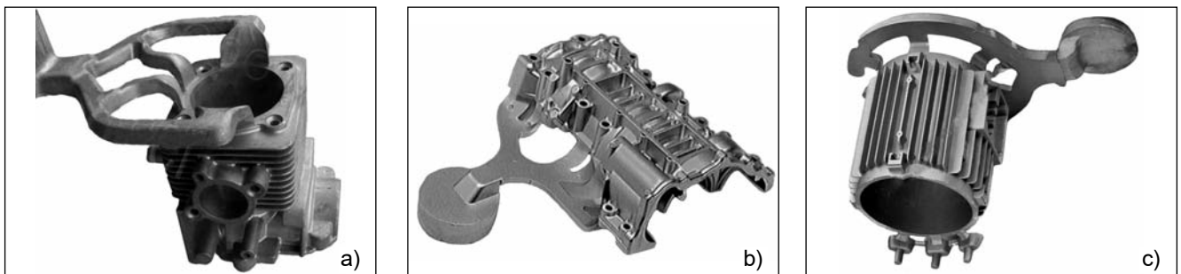
■ 3. ábra. Az optimális formatöltést elősegítő legyező alakú elosztórendszerek kialakítása
