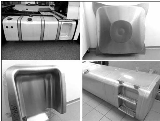
■ 4. ábra. Autóipari tartály véglemez, valamint fellépő foglalat (stepbox) prototípusok
