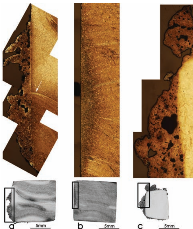
3. ábra. Kovácstűzben elégetett két damaszkolt és egy C15-ös próbatestből kivágott keresztmetszeti minták mikroszkópi képei
