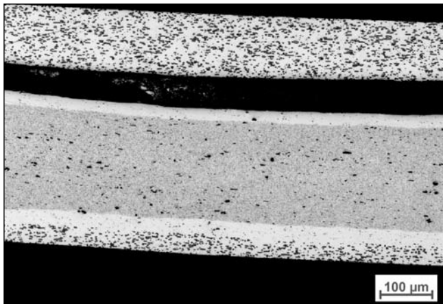
■ 14. ábra. Csiszolat az elvált plattírozott rétegekről
