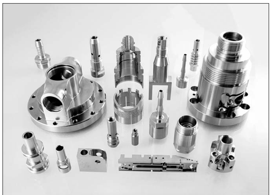
1. ábra. Sárgaréből forgácsolással készült alkatrészek [1]
