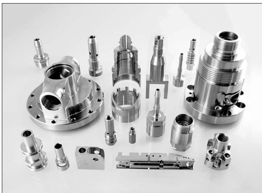
■ 1. ábra. Sárgaréből forgácsolással készült alkatrészek [1]
