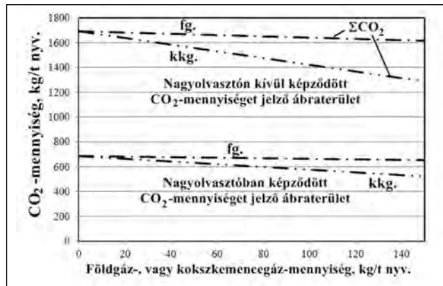
■ 3. ábra. A \text{CO}_2 -emisszió változása a befűjt tüzelőanyag és a maradék kocsz együttesének függvényében ISD Dunafer alapadatok bázisán (II.)
