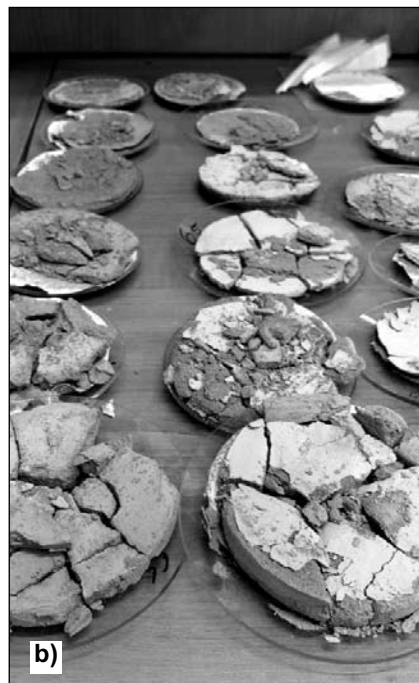
■ 5. ábra. A konvertersalokok alapvető laboratóriumi kioldási kísérletei (a, b – oldatok és maradványok, c – gázfejlődés a rázódoboz nyitásakor)
