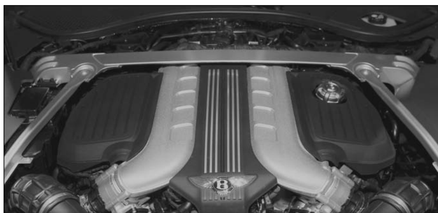
2. ábra. A toronymervítő beépítési környezete [2]
