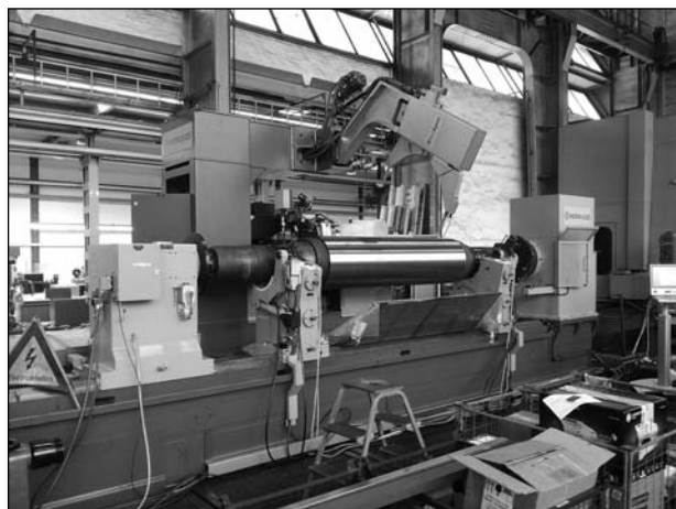
■ 2. ábra. ISD Dunaferri Zrt. által rendelt Herkules hengerköszörűgép a gyártó telephelyén
