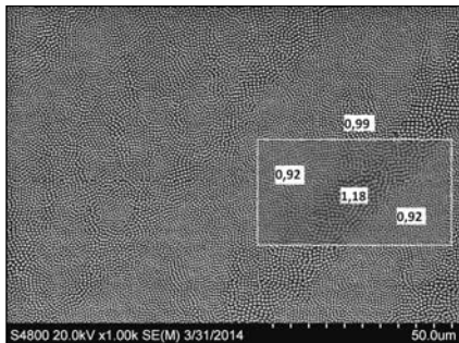
■ 8. ábra. Az eutektikus rudak közötti távolságban mérhető lokális különbségek
