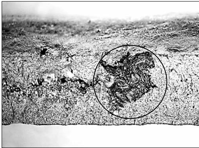
■ 6. ábra. K-próba szennyezett töretfelülete sztereomikroszkópon
