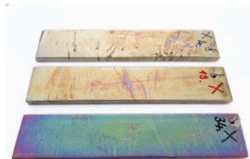
4. ábra. Az 50 × 50 × 5 × 60 mm méretű szögacélok (balra) és az 50 × 10 × 250 mm méretű lapos acélok (jobbra) növekvő mangántartalmú horganyfürdőben horganyozva
