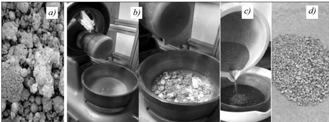
■ 5. ábra. A salakminták őrléssel és szitálással történő további feldolgozási folyamata (a – granulált salakmaradvány, b – dörzsmalom, c – szitálás, d – durva fémszemcsék)
