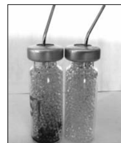
■ 5. ábra. Használt (balra) és új (jobbra) kondenzátumcsapda
