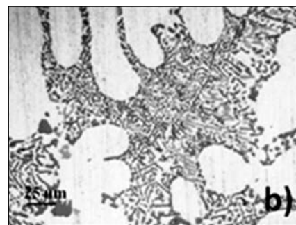
■ 1a-b. ábrák. Az Al–Si ötvözet eutektikumának kristályosodásakor kiváló szilícium morfológiája a) módosítatlan és b) módosított esetben, N = 500 ×
