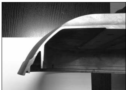
■ 3. kép. Vékony falú homokformázott öntvény 600 mm hosszón 2,7 mm-es átlagos falvastagsággal
