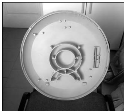
■ 6. kép. Vékony falú homokformázott öntvény 540 mm hosszón 3 mm-es átlagos falvastagsággal
