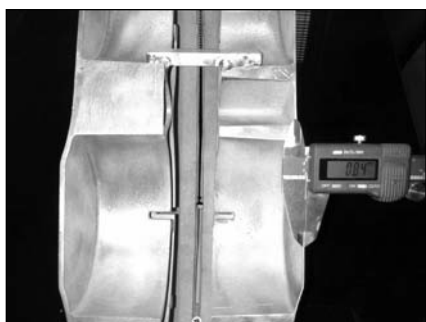
■ 4. kép. Vékony falú homoköntvény metszetei: a bal oldalon 540 mm hosszón 3 mm-es átlagos falvastagsággal, a jobb oldalon 540 mm hosszón 0,8-1,5 mm-es átlagos falvastagsággal
