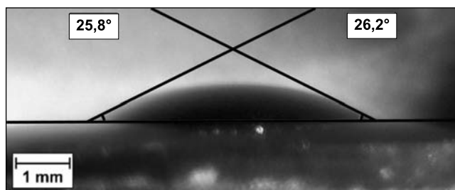
■ 3. ábra. A megolvadt forrasztás peremszög mérése
