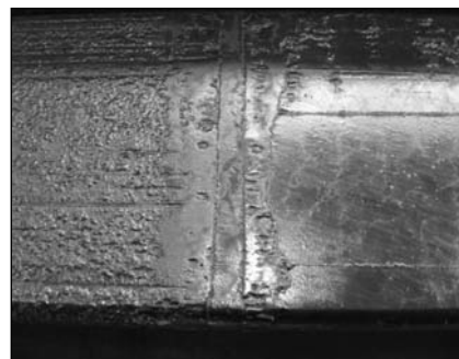
■ 2. kép. Balra: „túl erős” termodiffúzió eredménye
