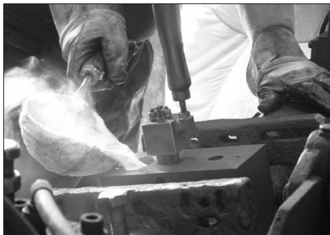
■ 8. ábra. A módosított kokilla öntés közben
