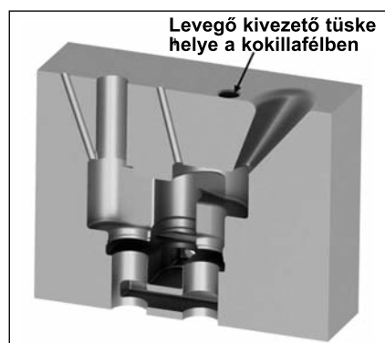
■ 3. ábra. A kísérleti kokilla egyik fele
