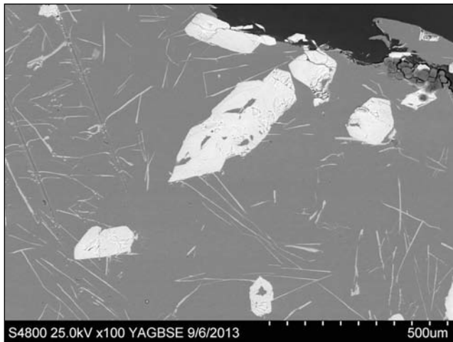
■ 2. ábra. A mintáról készített SEM-felvétel, benne a W-tartalmú szemcsékkel, illetve a szemcséről készített EDS-felvétel
