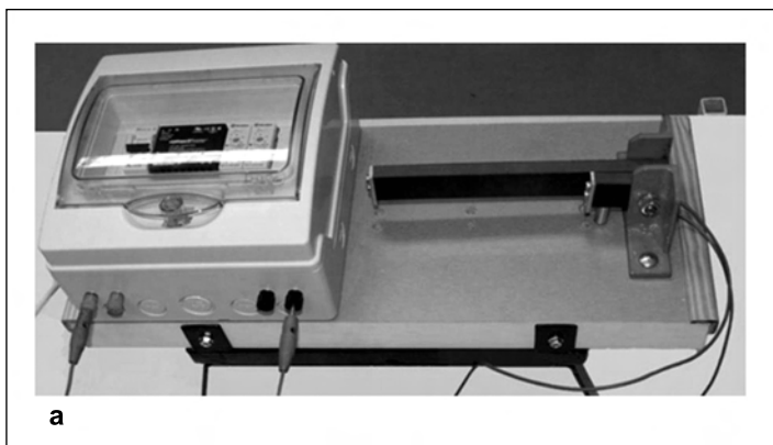
■ 4. ábra. A vizsgálóberendezés fényképe (a) és kapcsolási rajza (b); A berendezés részei: (1) mintadarab, (2) egyenáramú 24 V-os tápegység, (3) változtatható ellenállás, (4) terhelőkarok 3,5 mm átmérőjű acél csapágygolyókkal
