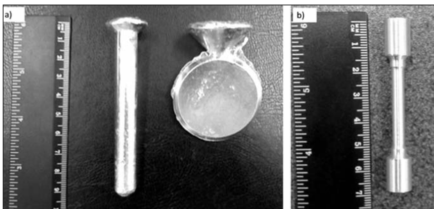
■ 3. ábra. Az öntéssel készült szakítópálca és érempróba előterméke (a), valamint a kimunkált szakítópálca (b)
