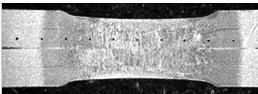
9. ábra. A keménységmérés helyei ponthegeesztett kötésben
