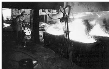
■ 2. kép. Kokillában kémiaiag féligcsillapított acél öntése
