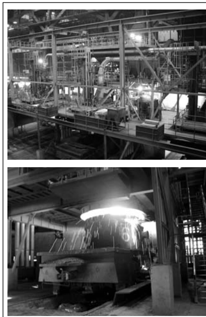
■ 5. kép. A háromállásos üstmetallurgiai állomás
