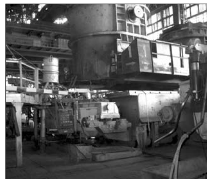
■ 4. kép. Öntés üstfordító állvánnyal
