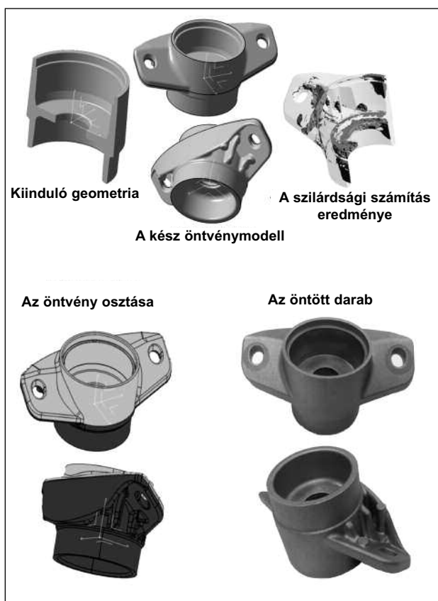
■ 4. ábra. Csapágycsillapító elem öntvényének fejlesztése
