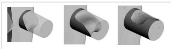
■ 3. ábra. A levegőbezáródás kialakulása a kiegyenlítő csapokban
