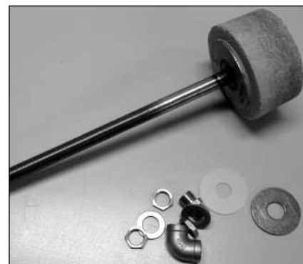
■ 3. ábra. A kemencefenékebe illesztett duplex argongáz-diffúzor
