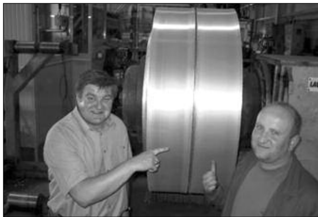
■ 6. ábra. Az ikerhengeres öntve hengerlő soron gyártott első kísérleti, dupla széles szalagtekercs
