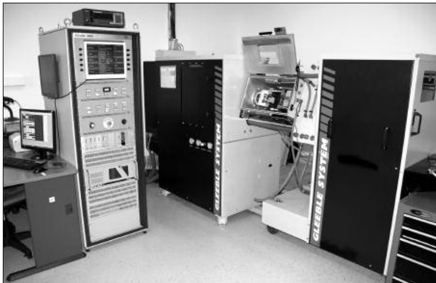
■ 1. ábra. A Dunaújvárosi Főiskola Műszaki Intézetében letelepített Gleeble 3800 típusú, Dynamic System Inc. által gyártott termomechanikus szimulátor
