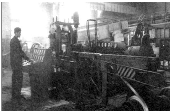
4. ábra. Az I. sz. szalagöntő gépsor kezelőpultja
