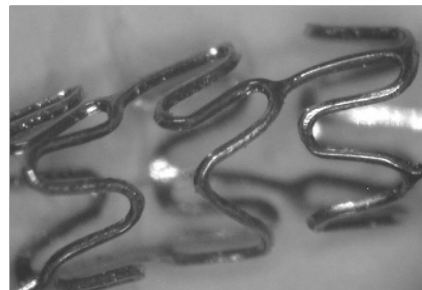
■ 5. ábra. A fotolitográfias kémiai maratással 2004-ig gyártott IVT-szent, amely a vágóballont is feltaláló magyar orvos, Baráth Péter találmánya
