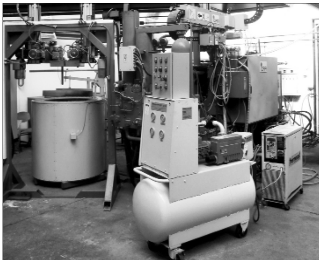
■ 4. ábra. A Miskolci Egyetem Metallurgiai és Öntészeti Intézet nyomásos öntőcellája, előtérben a kétkörös vákuumozó berendezéssel
