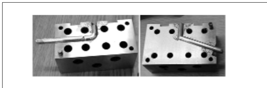
■ 30. ábra. Félig átsajtolt próbatestek a szerszámban
