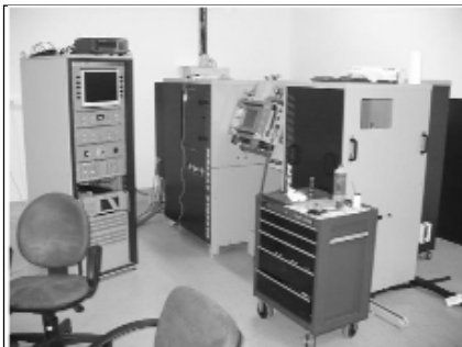
Gleeble 3800 fizikai szimulátor
