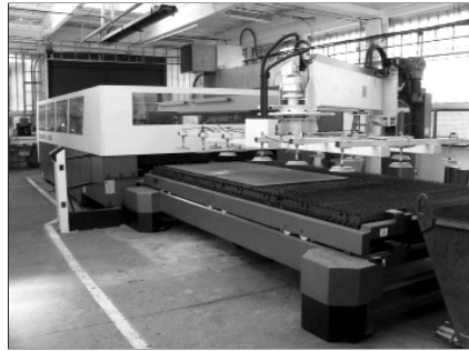
■ 10. ábra. 6 kW-os, 2x4 m asztalméretű lézeres vágóberendezés
