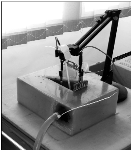
■ 3. ábra. Az intézeti felülettechnikai laboratóriumban összeállított Hull-cellás berendezés
