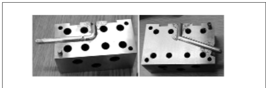
■ 30. ábra. Félig átsajtolt próbatestek a szerszámban
