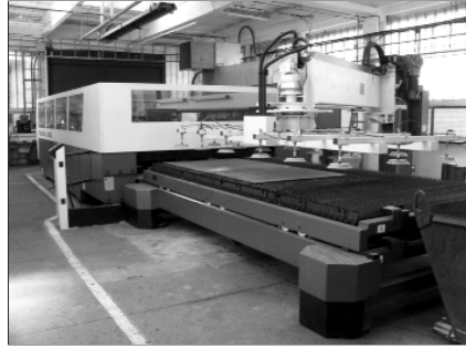
■ 10. ábra. 6 kW-os, 2x4 m asztalméretű lézeres vágóberendezés
