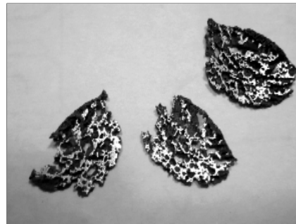
■ 10. ábra. Lipiddel stabilizált szinterelt titánhab szeletei, a szeletek átmérője 10 mm
