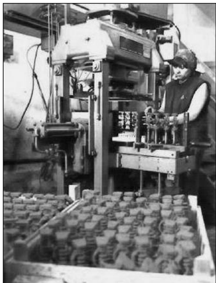
■ 6. ábra. A Röperwerk maglövőben gyártott belső furatmagok, 1970-es évek
