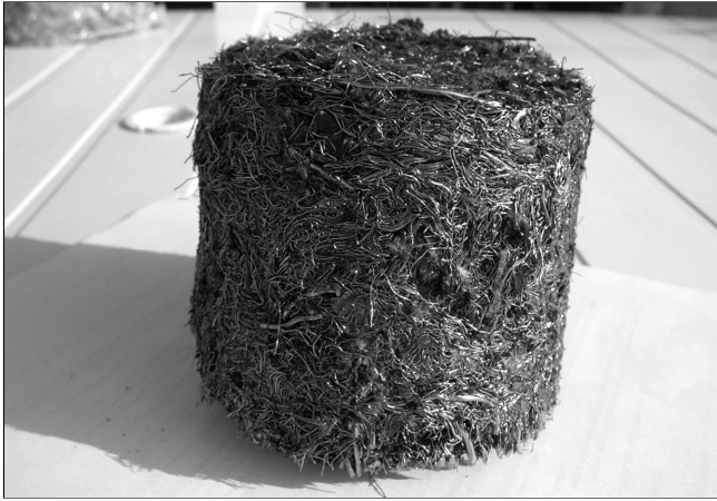
■ 7. ábra. Cordhuzal-hulladékok pakettálása (oldalnézet)
