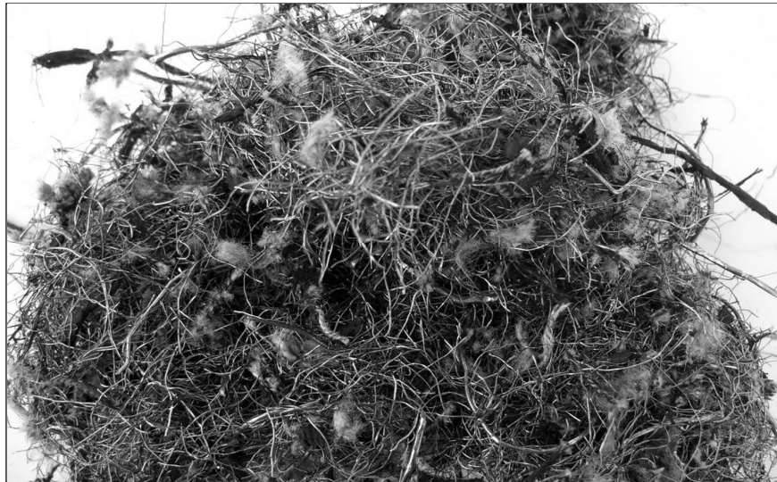
■ 4. ábra. Kétszeresen szredderezett cordhuzal-hulladékok
