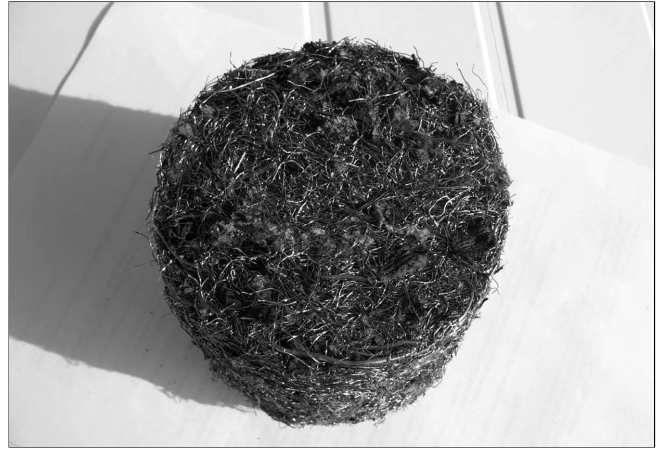
■ 8. ábra. Cordhuzal-hulladékok pakettálása (felülnézet)
