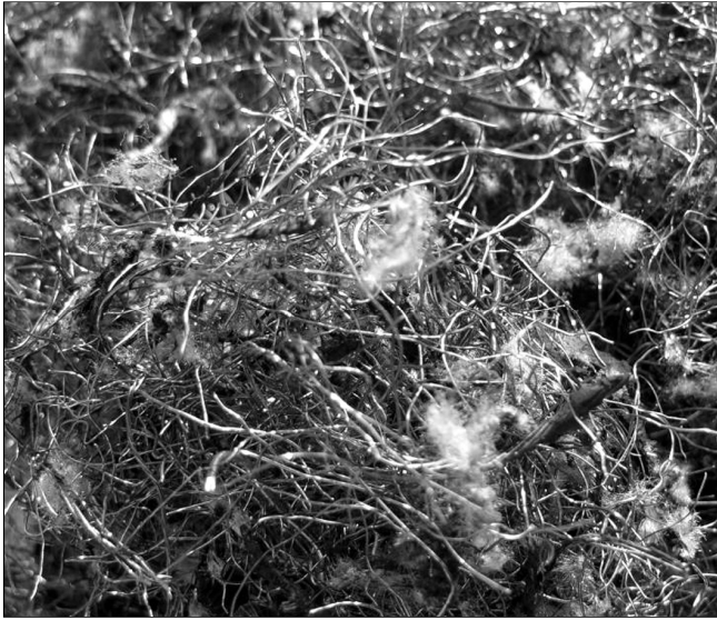
■ 2. ábra. Szedderezett cordhuzal-hulladék a hulladéktárolóból kiemelve
