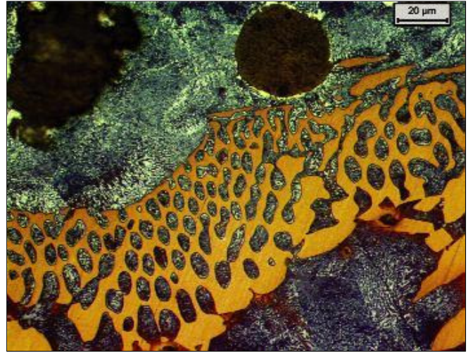
■ 5. ábra. Öntöttvas szövetszerkezetéről készült fénymikroszkópos felvétel 15 másodperces maratás után. (Eredeti nagyítás: 500x, Beraha CdS reagens) [3]
