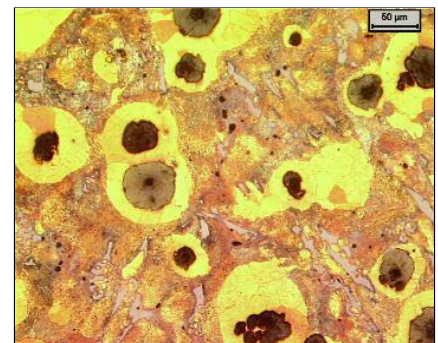
■ 8. ábra. Öntöttvas szövetszerkezetéről készült fénymikroszkópos felvétel 30 másodperces maratás után. (Eredeti nagyítás: 200x, Beraha Na-Mo II. reagens) [3]
