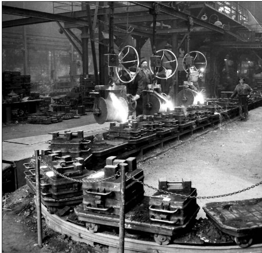
■ 8. ábra. Konvejsorsor a 2. sz. vasöntödében
