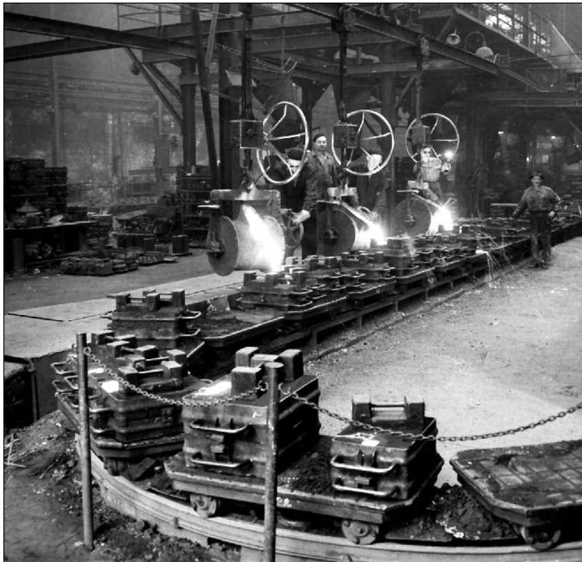
■ 8. ábra. Konvejsorsor a 2. sz. vasöntödében
