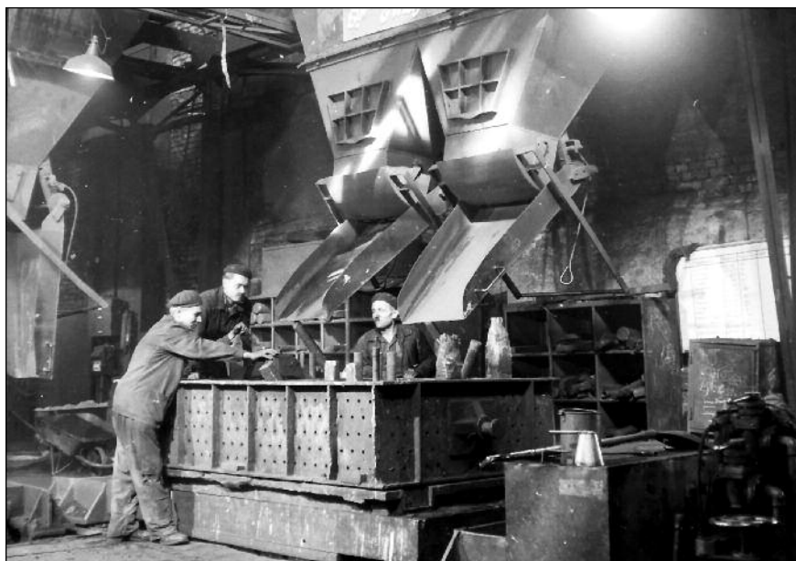
■ 7. ábra. Szerszámgépöntvény gépi formázása az 1. sz. vasöntödében (a kép néhány évvel később készült)
