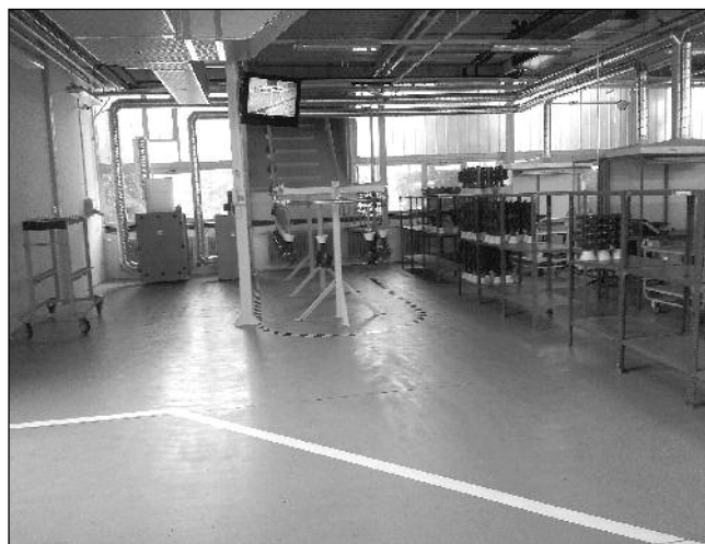
■ 2. kép. Kamerával figyelt új konvektor viszi a mintákat az emeletre
