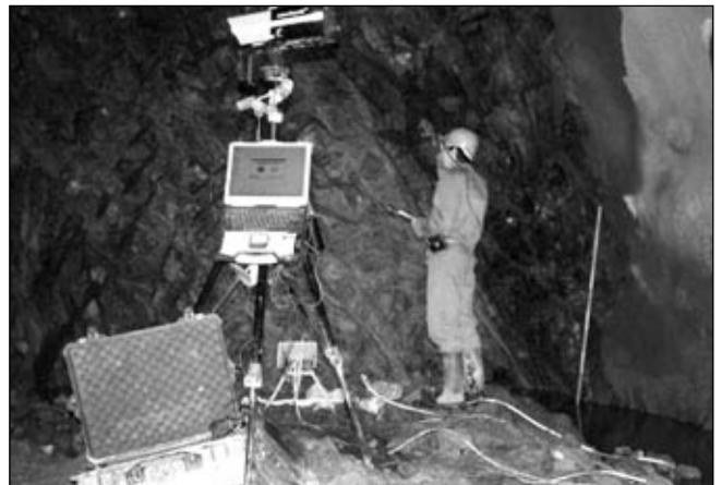
10. ábra: Vágat geotechnikai dokumentálás
