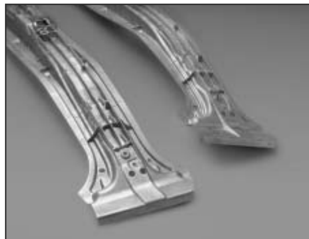
6. ábra. AURAL-2®-ből készült Porsche hosszlevegőkar, AURALTHERM®-eljárással hőkezelve
