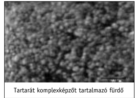
■ 5. ÁBRA. SEM-felvételek a K-Na-tartarát komplexképzőt tartalmazó fürdőből leválasztott Ni mintákon
