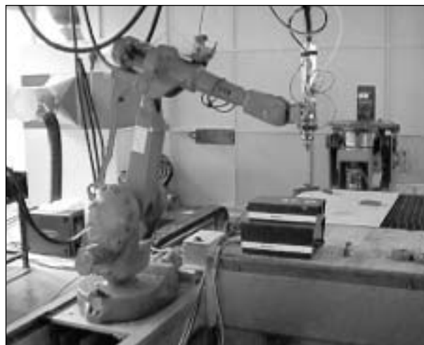
■ 2. ÁBRA. 2,7 kW fénytjeljesítményű Nd:YAG lézer
