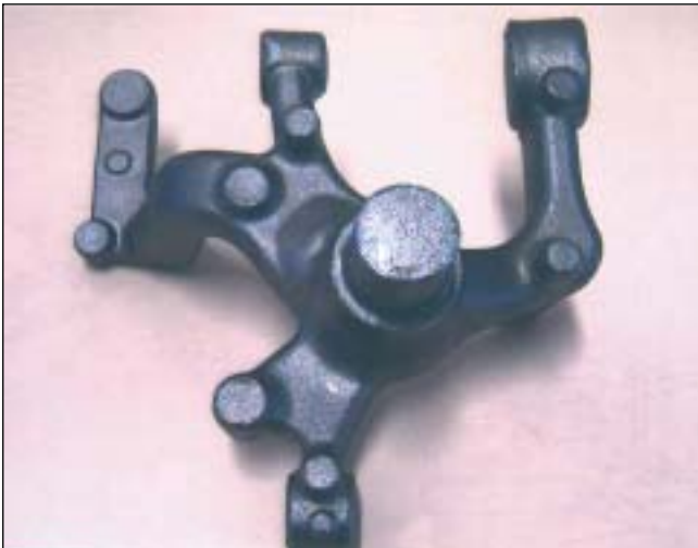
■ 7. ÁBRA. A Volkswagennek a BN Kft. alapanyagából kovacsolt hátsó hibaféltengelye
