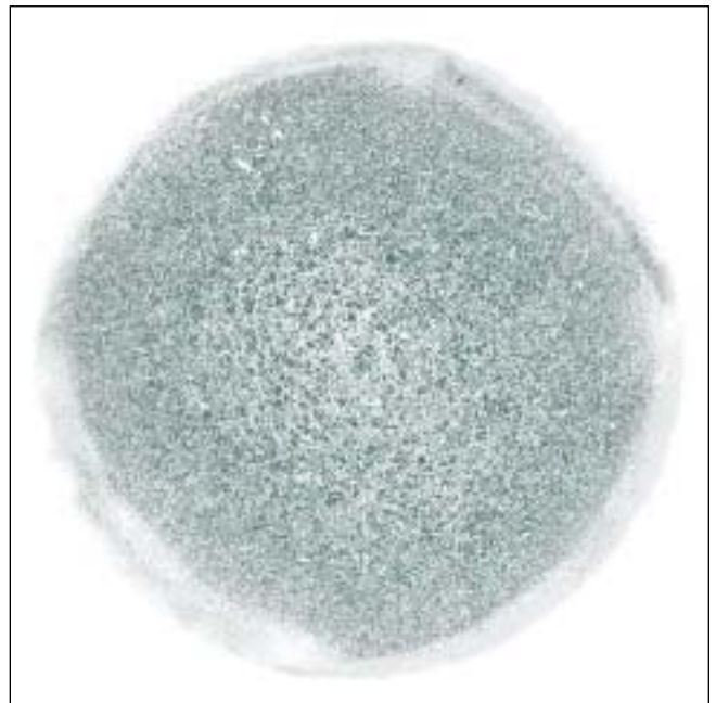
■ 6. ÁBRA. Hengerelt köracél Baumann-lenyomata
