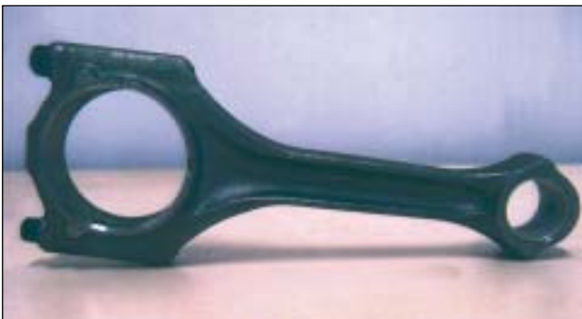
■ 8. ÁBRA. Kénötvözésű dugattyúmozgató hajtókar
