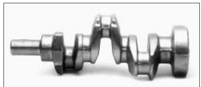
■ 3. ÁBRA. Újrakéneztett acélból gyártott kovácsolt termék
