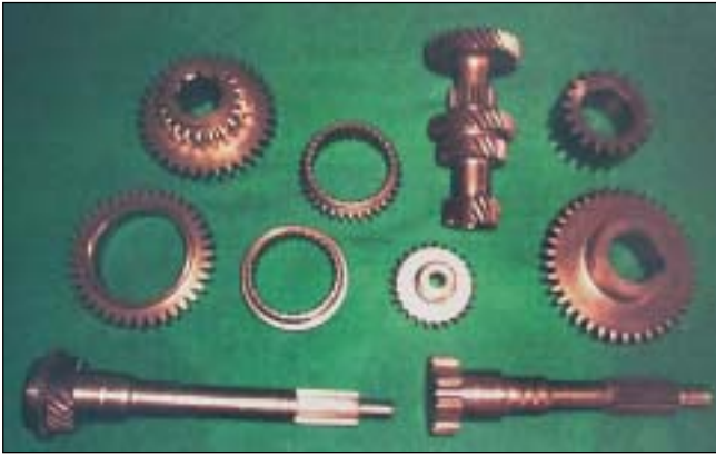
■ 4. ÁBRA. Sebességváltó mű alkatrészei
