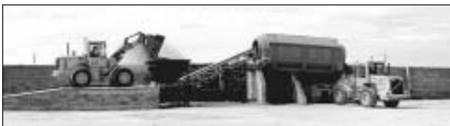
■ 3. ÁBRA. Az aprított vegyes alumíniumhulladékot osztályozó dobszita
