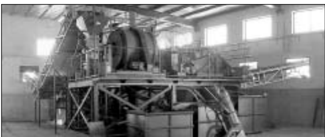
■ 4. ÁBRA. Sorba kötött kétlépcsős flotálóberendezés
