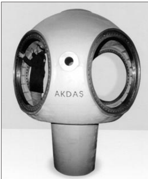
■ 4. kép. Egy Akda acélöntvény. Szélkerékfej, 12.500 kg
