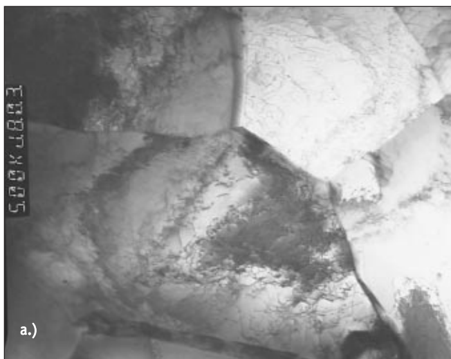
1. ábra. 15Mo3 típusú acél TEM-képe (a) és az ötszög alakú szemcse elektrondiffrakciós ábrája (b)
