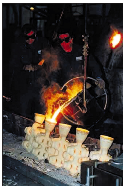
■ 10. ábra. Öntés az önhordó keramikus héjformákba
