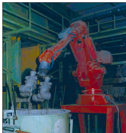
■ 9. ábra. Az első mártást kézzel, a többi réteg bevonását ezzel a a robottal végzik
