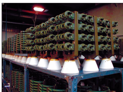
■ 8. ábra. Kerámia beömlőtölcsérrrel ellátott viaszbokrok bevonás előtt
