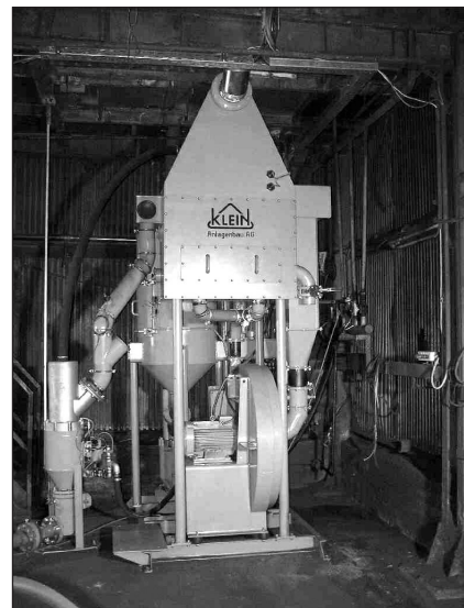
3. ábra. A Klein-féle új homokregeneráló
