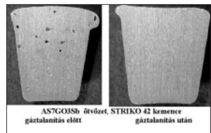
■ 6. ábra. A gáztalanítás hatása a vákuumban megszilárdult, sűrűségindex-mérésre szolgáló próbatéscsiszolatán
