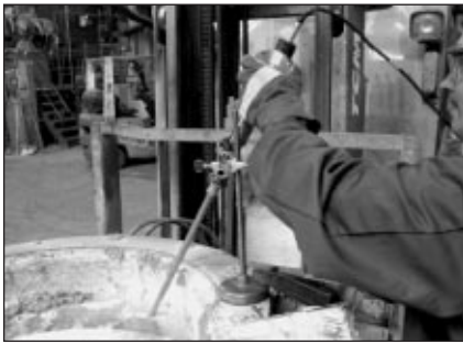
■ 1. ábra. A hidrogénszenzor mérés közbeni elrendezése
