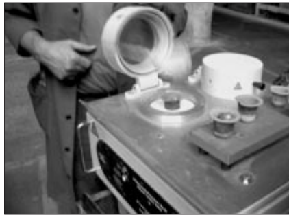
■ 2. ábra. A sűrűségindex vizsgálathoz a 80 mbar nyomáson kristályosodást biztosító készülék
