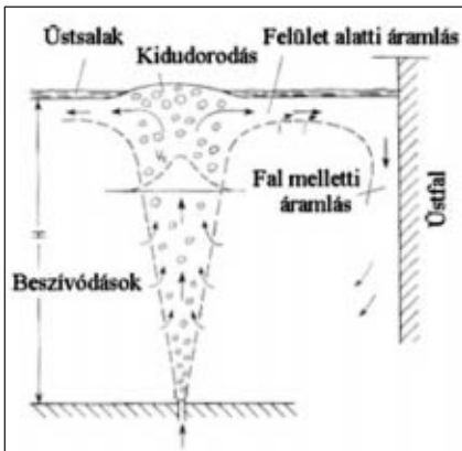
■ 2. ábra. Alsó átöblítésnél az argonfáklya elhelyezkedése [2]
