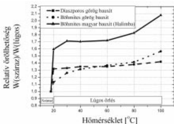
8. ábra: Relatív őrölhetőség hőmérséklet függése CaO adalékanyag alkalmazása mellett [6]
