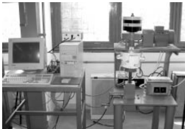
1. ábra: Univerzális Hardgrove-malom és szabályozó-, mérésadatgyűjtő rendszere [4]
