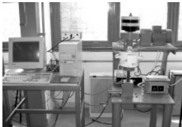
1. ábra: Univerzális Hardgrove-malom és szabályozó-, mérésadatgyűjtő rendszere [4]
